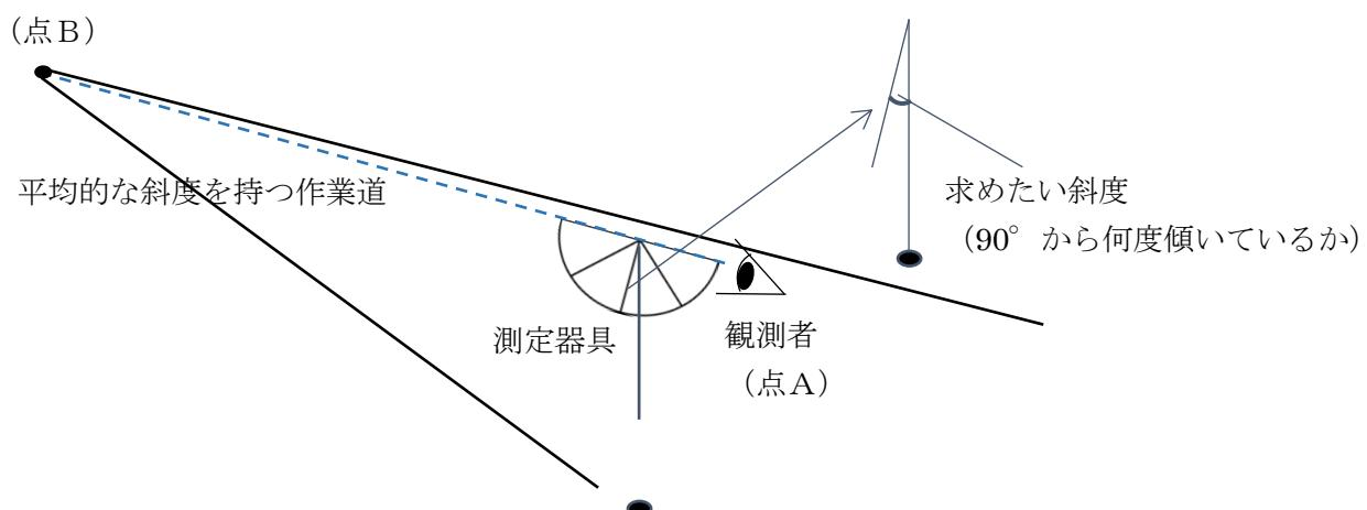
(計算式) 水平距離（取組延長） = 延長斜距離（実測） × 補正係数
