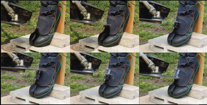
↑自社にて刈払い機接触テストの様子(一般的なモデル、通常出力で数秒間接触) ※防護板の機能は弊社独自の設定で、安全基準(JSなど)の規格に該当するものではありません。
